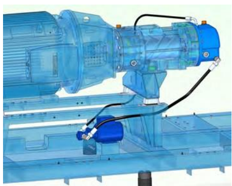
Рис. 16: Насос для смазки редуктора ступени компрессора
