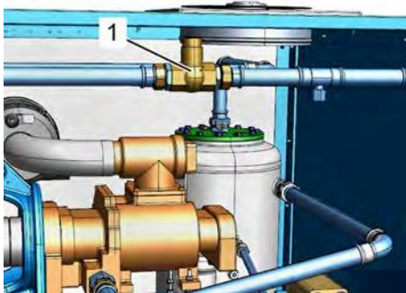
Рис. 18: Клапан минимального давления/обратный клапан
