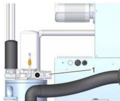
Рис. 11: Клапан минимального давления с функцией обратного клапана
