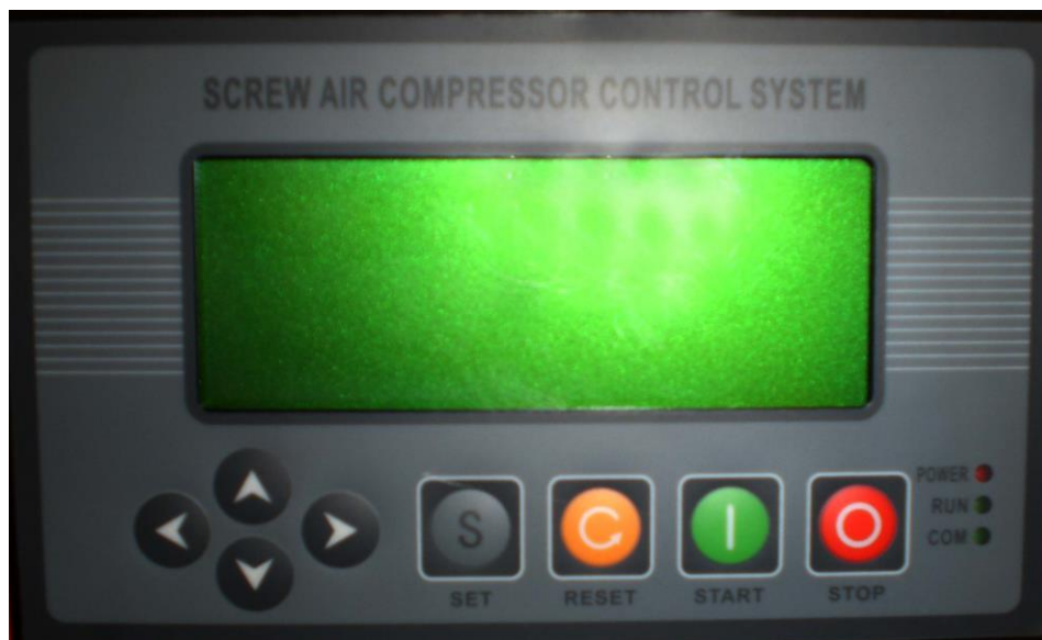
Рисунок 5 – Дисплей и кнопки на панели оператора. Если внешний вид панели отличается от вашего – обратитесь к руководству по эксплуатации контроллера из комплекта документов к станции.
