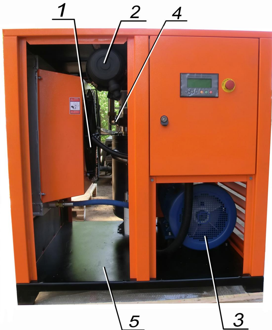
Рисунок Б.3 – Вид на щит управления станции компрессорной электрической ЗИФ-СВЭ (типа АРМ)
